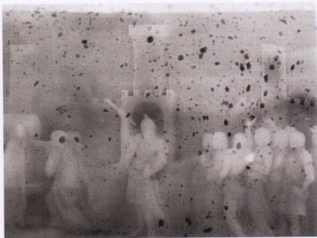
3. Dettaglio radiografico della formella con Storie di Giosuè , che mostra la notevole quantità di bolle presente nel getto.
