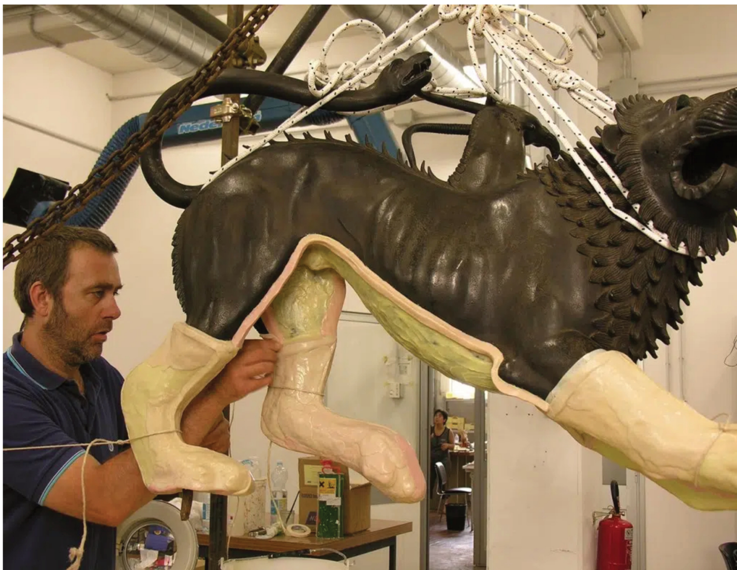
L'esecuzione del calco in silicone della Chimera dall'originale custodito al museo
